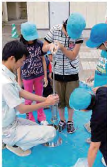
実験器具のランマーを使うと、手で固めるのとは違う硬さになる。みんなも大興奮!
