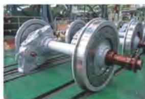
▲高速鉄道用軽量輪軸 ▲東海道新幹線 N700A(のぞみ) ©東海旅客鉄道株式会社
